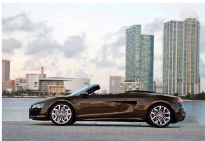
De fibra de carbono e alumínio, o conversível é peso-leve: só 1 720 quilos
